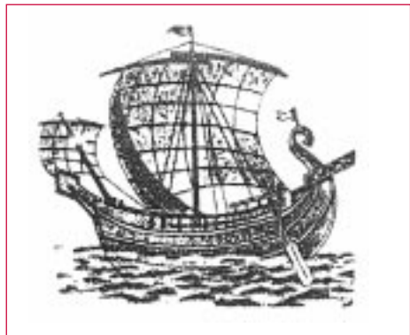
Nave mercante fenicia, ano 100 a. C. Sacada dun sarcófago de Sidón, construída xa con quilla e cadernas, parecida na súa forma ás naves mercantes gregas e romanas desta época.
