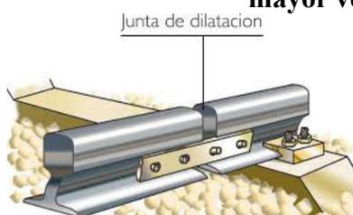
Las vías del tren tienen esa separación, porque cuando hace mucha calor las vías se dilatan y esa separación desaparece. Para que la vía no se rompa, se deja esa separación.
