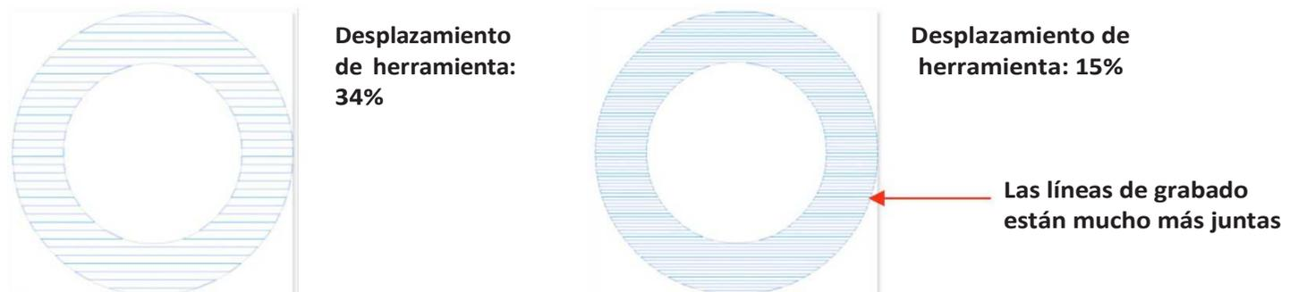
**Desplazamiento del sombreado (Hatch Offset):** Esta configuración controla la distancia desde el relleno del grabado hasta el perímetro exterior de la forma original, de nuevo como un porcentaje del diámetro de la herramienta. Una configuración de 0% extenderá el patrón hasta el perímetro:
