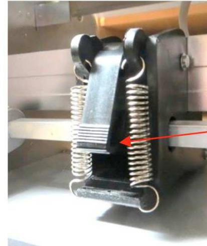
La palanca está en colocada hacia abajo. NO use esta posición a menos que este realizando el corte de materiales densos.
