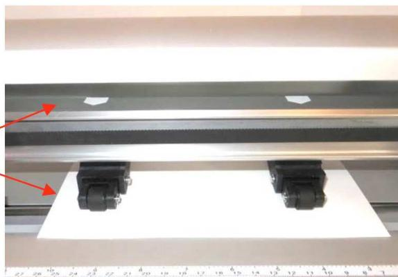
O... Coloque el papel sobre la estera de corte y luego inserte la estera de corte en el cortador
