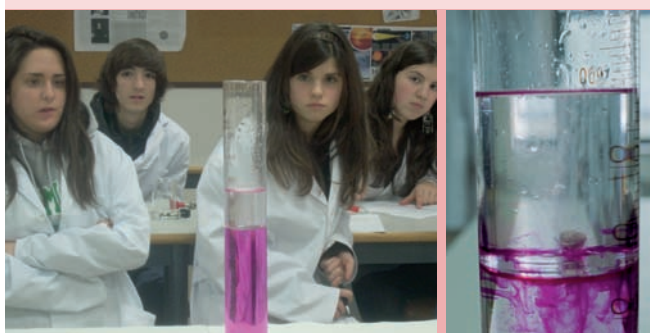
Figura 5. Reacción del sodio en agua en presencia de un indicador y de hexano.
