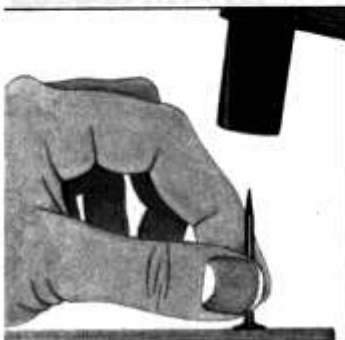
Embotado de punta: se evita agrietado
