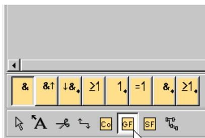
Con un clic del ratón puede insertar la función seleccionada en la interfaz de programación. La primera función del grupo está preajustada, las demás funciones se pueden seleccionar con el ratón antes de posicionarlas.
