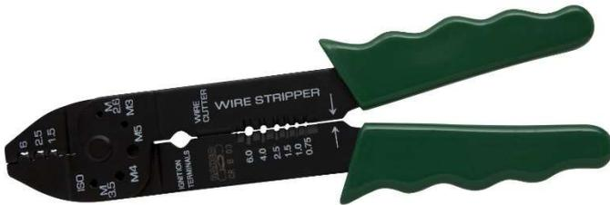
El cable se coloca en la ranura correspondiente a su diámetro y al cerrar la abrazadera cae en la ranura cortando su funda. Luego, muévelo de un lado a otro y separa la tapa del cable de cobre.
