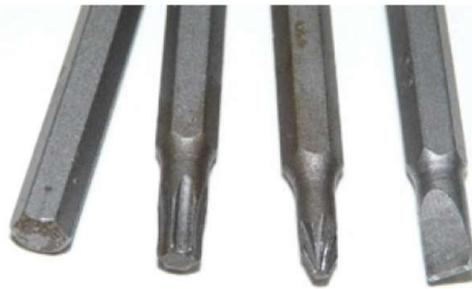
Diferentes tipos de cabezas de destornilladores (hexagonal o Allen, TORX, de estrella y plano).
