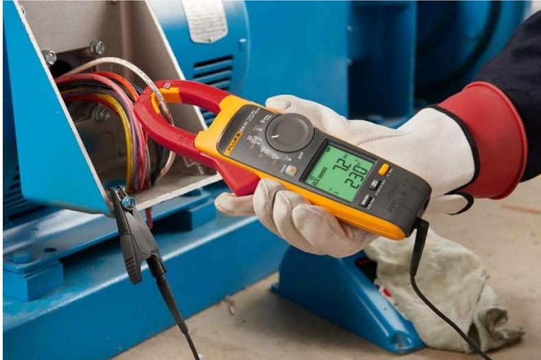
Usando la pinza amperimétrica
