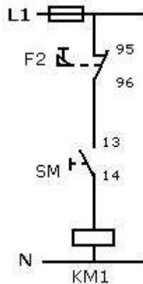
2. Esquema de Marcha – Paro de un contactor con preferencia del paro. Con SM conectamos KM1 y al soltarlo sigue en marcha porque el contacto de KM1 realimenta a su propia bobina. La parada se realizará mediante SP y por protección térmica a través de F2.
