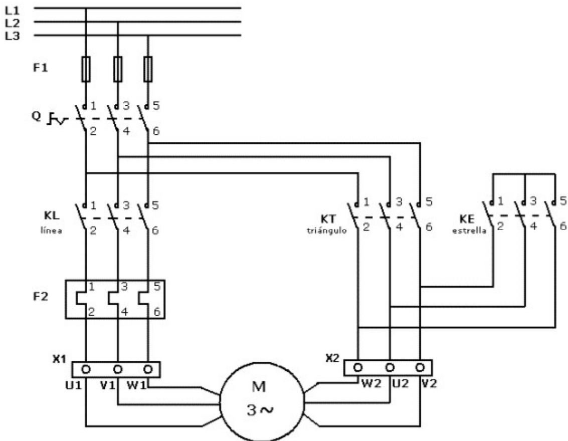
Esquemas de mando existen varios, uno de ellos es el de figura siguiente que es uno de los más seguros que hay. Por ejemplo; si KL no funciona la maniobra no se inicia, una vez utilizado el temporizador este es desconectado, si KT está clavado no arranca el motor, etc.
