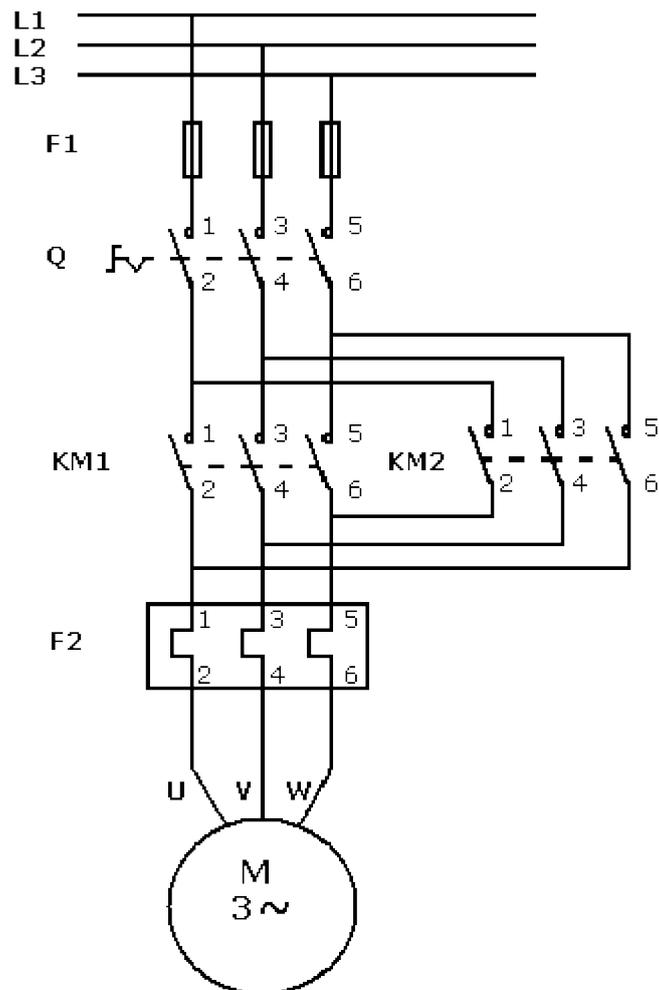
En el esquema de mando tendremos que tener la precaución de que los dos contactores no puedan funcionar a la vez, ya que ello provocará un cortocircuito a través del circuito de potencia. Para evitarlo se montarán unos contactos cerrados, llamados de enclavamiento, en serie con las bobinas de los contactores contrarios. En el mercado también existen contactores ya contruidos a tal efecto que incluyen unos enclavamientos mecánicos para una seguridad adicional.
