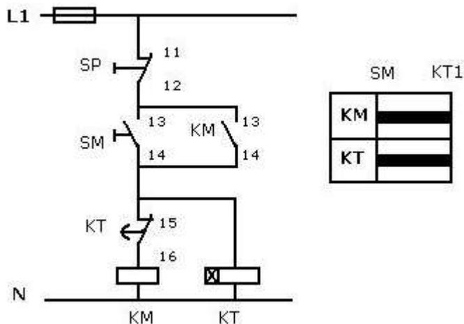
10. Conexión de KM pasado un tiempo del accionamiento de SM. Parada por SP.
