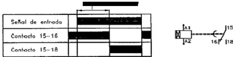
Temporizador a la conexión: cuando conectamos la bobina, y la mantengamos así, los contactos cambiarán pasado el tiempo que tengan programado. Una vez desconectada estos vuelven inmediatamente a su posición de reposo.
