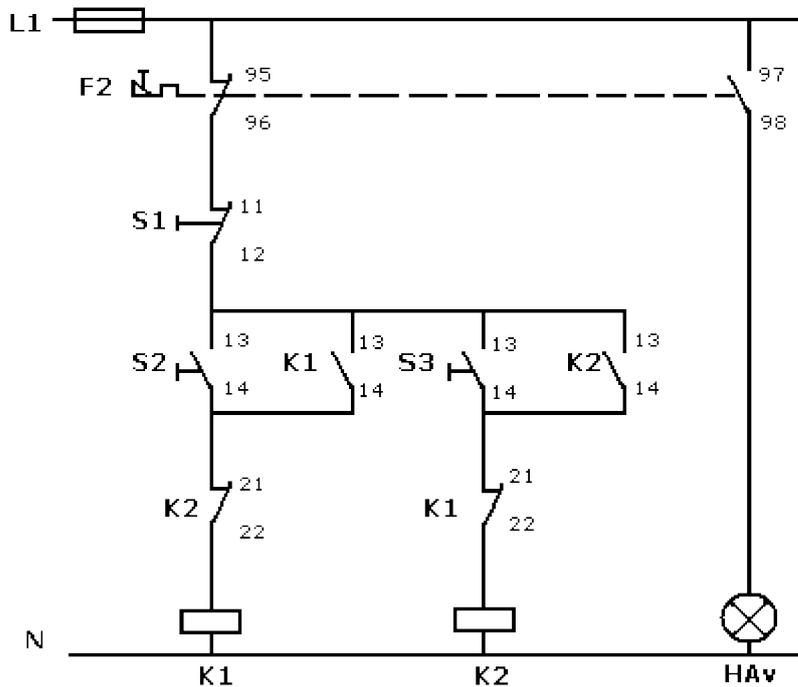
8. Inversor de giro sin pasar por paro. Mando de dos contactores a través de los pulsadores S2 y S3. Parada del motor por avería F2 o el pulsador S1. Sólo puede funcionar uno y la inversión de marcha no es necesario pasar por paro.
