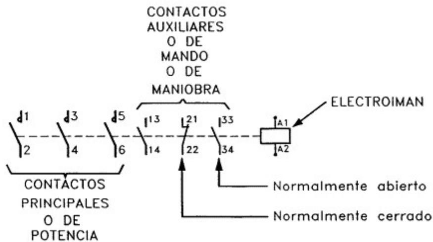
Si el contactor NO tiene contactos de potencia entonces se le llama relé auxiliar.
