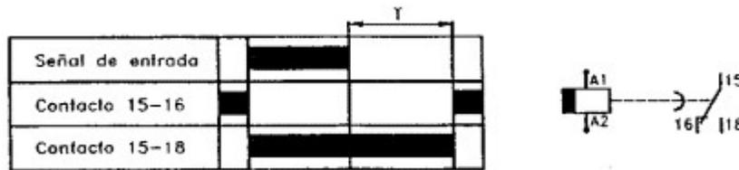
Temporizador a la desconexión: al activar la bobina los contactos cambian inmediatamente y es al desconectarla cuando temporizan, pasado el tiempo programado retornan a reposo.
