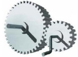
2. En el siguiente dibujo sabemos que el engranaje motriz gira a 4000 rpm y tiene 14 dientes y el conducido 56
