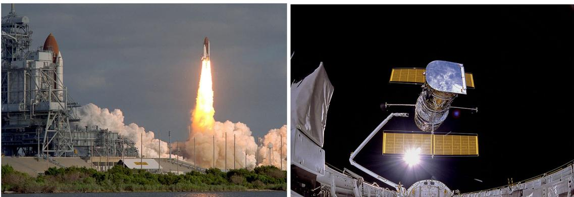
Despegue del Discovery con el Hubble y despliegue con el brazo robótico.
