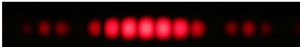
Ademais, se nos fixamos no máximo principal, este pode aparecer seccionado nunha serie de zonas brillantes separadas por zonas escuras -máximos e mínimos-. Isto débese a un fenómeno de interferencia producido polos bordos do cableo, resultando sobrepostas unha difracción e unha interferencia.
