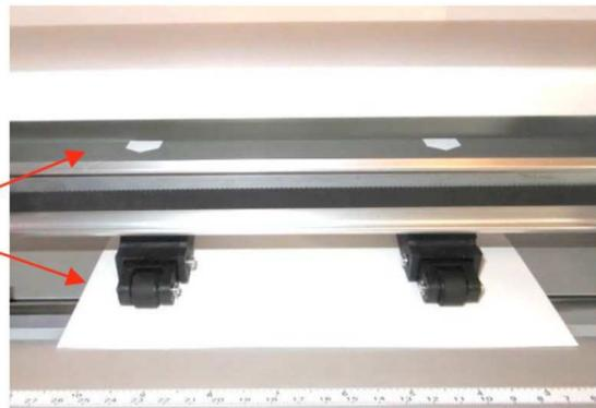
O... Coloque el papel sobre la estera de corte y luego inserte la estera de corte en el cortador
