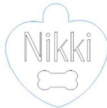
• Debido a que se desea un grabado relleno, seleccione el texto y la forma del hueso y utilice el **Módulo de Grabado** (Engraving Module) para rellenar el diseño con líneas. Los detalles sobre esta función se presentan en la *Sección 5.03*.
