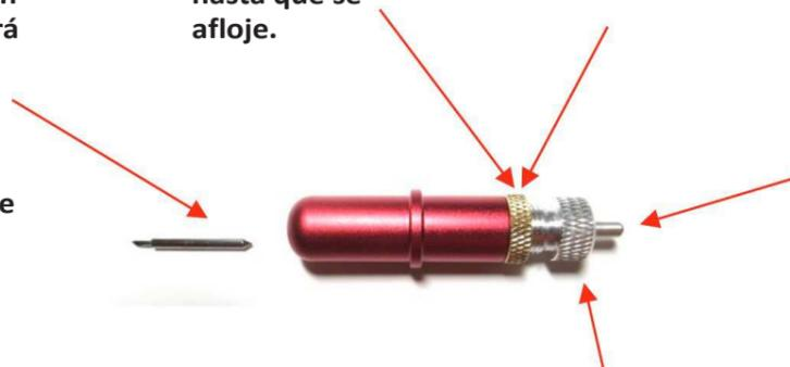
**4. Gire el anillo grande en el sentido de las agujas del reloj o en el sentido contrario a las agujas del reloj para establecer la longitud de la cuchilla para que coincida con el grosor del material que se va a cortar.**
