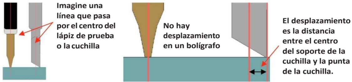
• Si configura la **Desviación de la hoja** en 0 al cortar con una hoja, las esquinas se redondearán. Por otro lado, si está configurado demasiado alto, las burbujas se cortan en las esquinas agudas:
