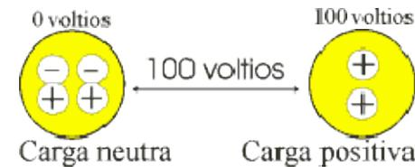
el flujo de corriente siempre se produce cuando el movimiento de electrones se realiza en una sola dirección, desde una carga negativa a una carga positiva. Para ello, es necesario que exista una diferencia de potencial entre ambos puntos, es decir, un exceso de electrones en un punto (negativo) y un defecto de electrones en el otro (positivo).
