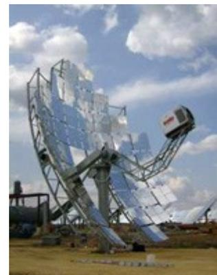
Disco Stirling con diseño propio Abengoa Solar
