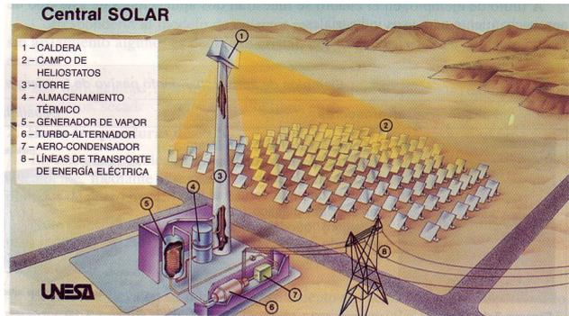
Figura 3.21. Campo de heliostatos.
