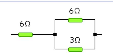
**10.** Segundo a montaxe da figura, cal será o valor da resistencia total?
