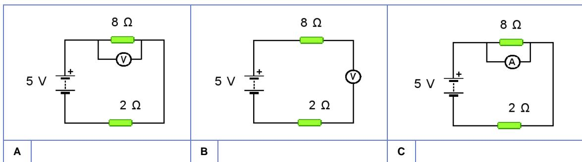
**15.** Tendo en conta o esquema da figura, e que circula unha corrente de 2 A, canto valerá V?
