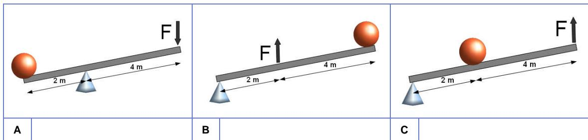
20. Que forza teríamos que realizar segundo o esquema da dereita para equilibrar a resistencia de 600 N?
