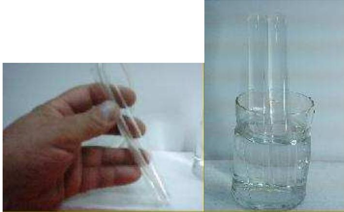
3. Succionar lentamente, a través de la manguerita, hasta que no quede ninguna burbuja de aire en el tubo, cuidando que el agua con vinagre no llegue a la boca. Efectuar la misma operación con el segundo tubo.
