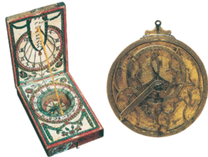
O compás servía para manter o rumbo. O astrolabio determinaba a latitude a partir da posición das estrelas.
