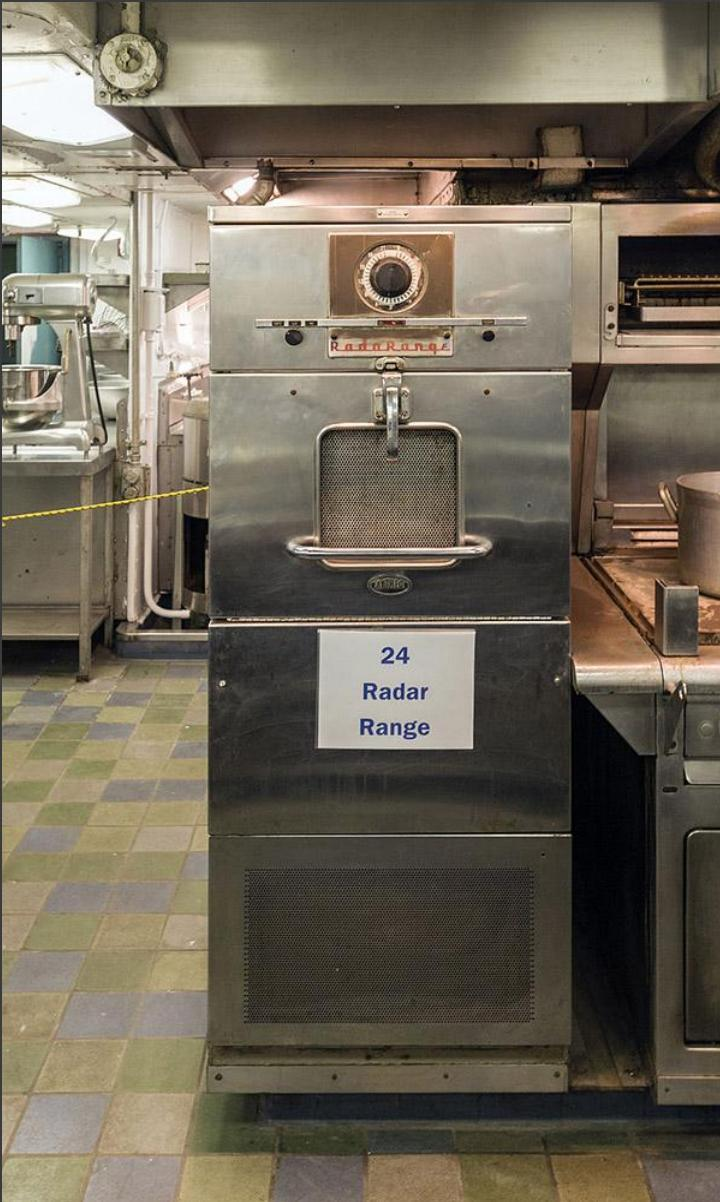
**Spencer deseñou una caixa metálica cunha abertura pola que podía entrar a radiación do magnetrón. As paredes metálicas confinaban a radiación, polo que a enerxía do campo electromagnético non se difundía, senón que se concentraba dentro das paredes. Cando se introducía alimento, a súa temperatura aumentaba. Contra o final de 1946, a Raytheon Company patentou os microondas para a preparación dos alimentos.**
