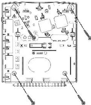
Figura 2-2 Plantilla de montaje atornillada
