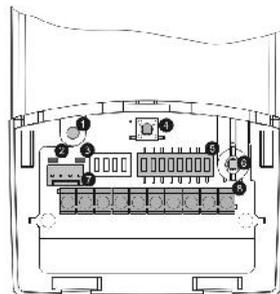
1. Agujero del tornillo opcional (se utiliza para sujetar las cubiertas delantera y trasera)
