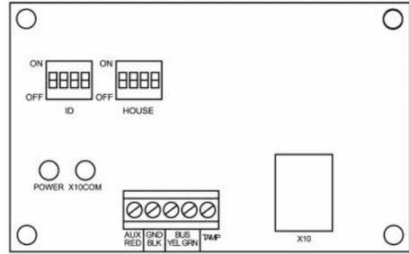
Figura 3- 6: Salida de Utilidad módulo X-10
