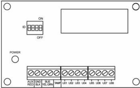
Figura 3-5: Módulo de Salida de Utilidad EO8
