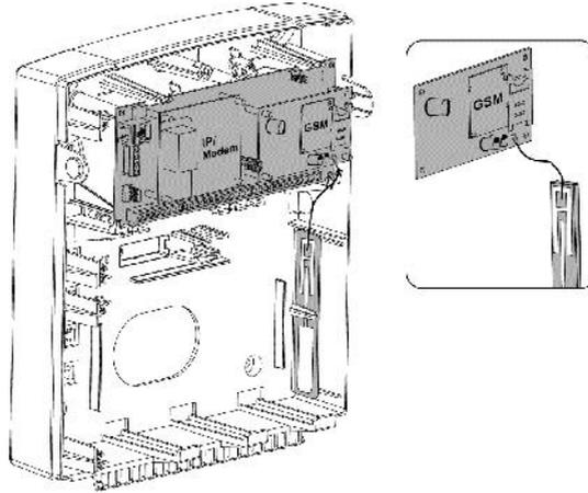
Figura 2-11 Colocación del panel GSM/GPRS y antena
