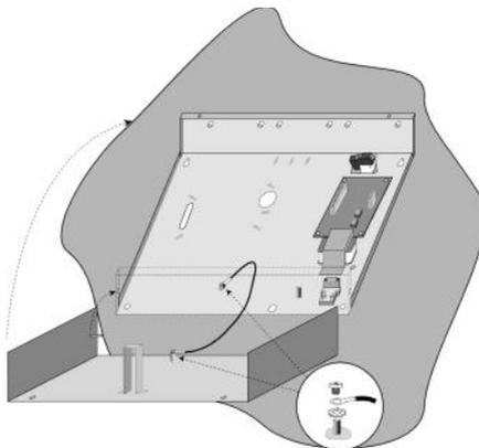
Figura 3-9: SMPS dentro de caja metálica
