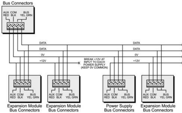
Figura 2-7: Terminal de Conexión de conectores Bus
