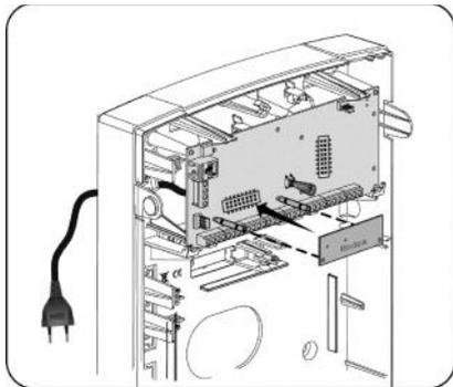
Figura 2-13 Colocación del módem de rápida comunicación
