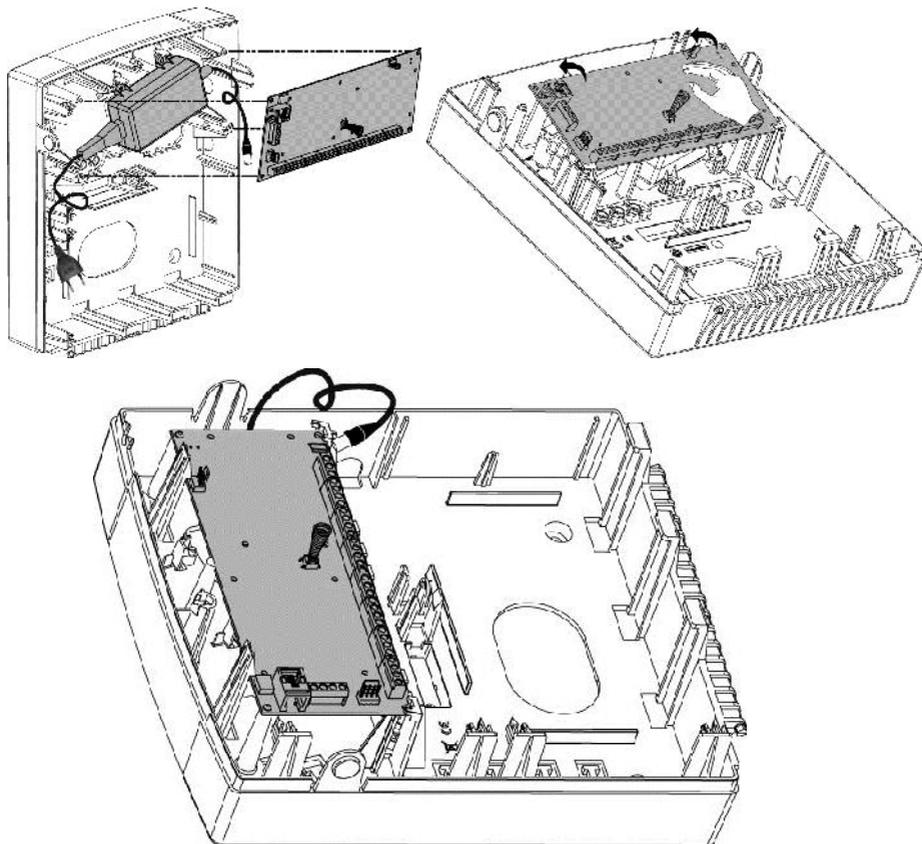
Figura 2-4 Colocación del panel principal
