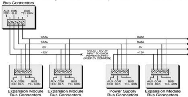
Figura 3-1: Terminal de Conexión de conectores Bus
