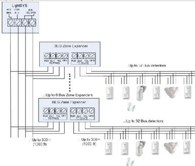
Cuando están conectados a LightSYS, los expansores de zona Bus pueden definirse para soportar 32 zonas de Bus. Hasta 4 expansores de zonas Bus pueden ser conectados a LightSYS.
