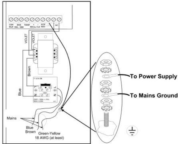
Figura 3-10: SMPS - CA y conexión a tierra
