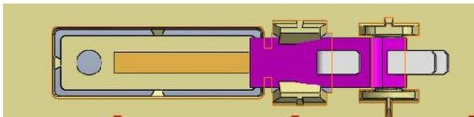
Figura 2-10: Liberación y conexión al PCB
