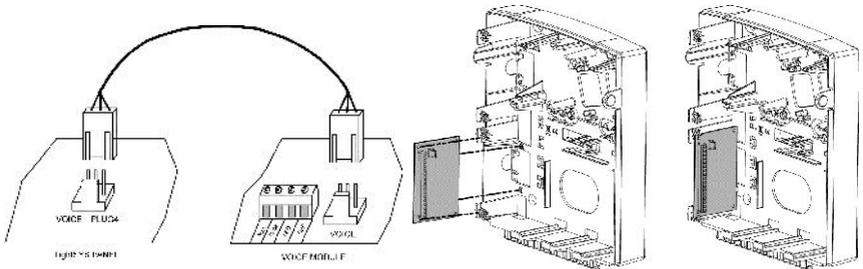
3. Monte el módulo de voz en el interior de la caja de plástico con el panel principal LightSYS, con el fin de establecer una conexión entre las dos unidades. (Como anteriormente)
