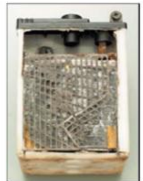
Placa de una batería rota (no recuperable).
