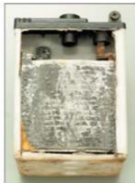
Placa de una batería sulfatada (recuperable).
