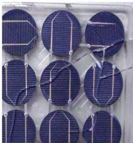
Ejemplos de efectos de los puntos calientes: rotura del vidrio del panel (izquierda) y deterioro del laminado FV v del contacto metálico (derecha).
