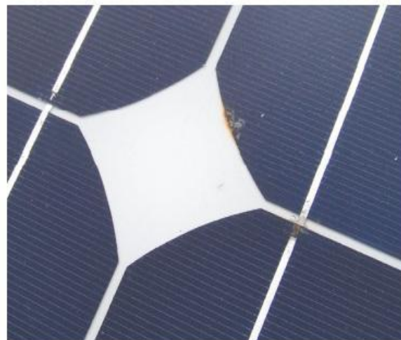
Ejemplos de efectos de los puntos calientes: rotura del vidrio del panel (izquierda) y deterioro del laminado FV v del contacto metálico (derecha).
