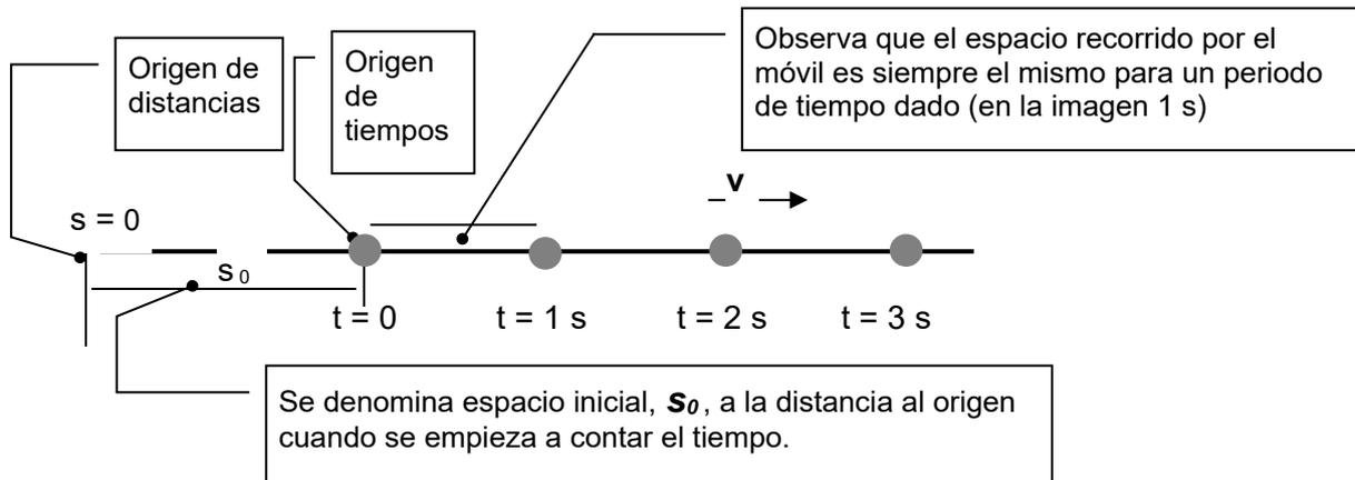
**La gráfica  $s/t$  es una línea recta. La inclinación (pendiente) nos da la velocidad. El punto de corte con el eje vertical da  $s_0$**
