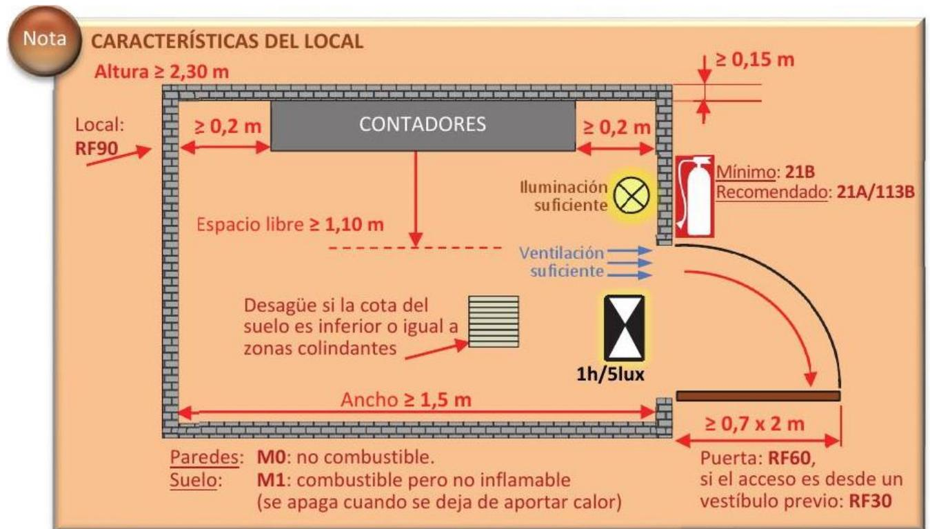
Estará suficientemente ventilado, disponiendo de una rejilla de ventilación en la pared (queda expresamente prohibido realizarla en la propia puerta de acceso al “cuarto”, salvo que esté diseñada con cierre “anti-incendio”).
