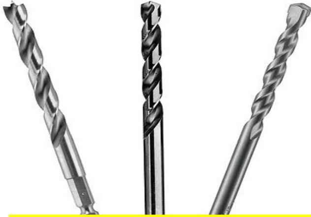
**Brocas.** Es una barra de acero templado muy duro, afilada por un extremo, que al girar puede penetrar en un cuerpo y cortar pequeñas porciones llamadas **virutas**. Hay distintos tipos de brocas según sea el material a taladrar; así, utilizaremos brocas para metal en cuadros eléctricos metálicos, brocas para piedra y similares para colocar abrazaderas en una pared, brocas para madera si necesitamos colocar un halógeno en un mueble de madera.
