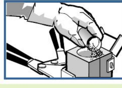
Abrir la tapa negra del cartucho y espolvorear el polvo de ignición sobre el de soldadura y en el borde del molde, bajo la abertura de la tapa, para facilitar su ignición.
