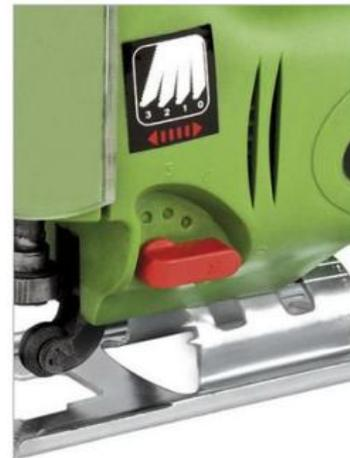
Detalle de la regulación pendular de la hoja. Para no dañar el metacrilato se dejara en el centro. Para la chapa de acero se puede subir hasta el uno.
