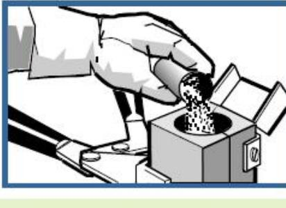
Abrir la tapa de color del cartucho y vaciar el polvo de soldadura en la tolva del molde.
