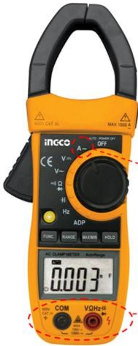
Para medir intensidades en alterna escogemos con el dial rotativo Amperios en alterna y rodeamos con la pinza el cable por el que pasa la intensidad que queremos medir como indica la figura de la derecha.
