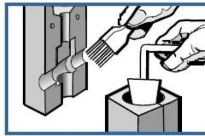
Eliminar la escoria de la tolva, el orificio de colada y la tapa del molde con el rascador de moldes. Limpiar los restos de suciedad de la cámara de soldadura con una brocha.
