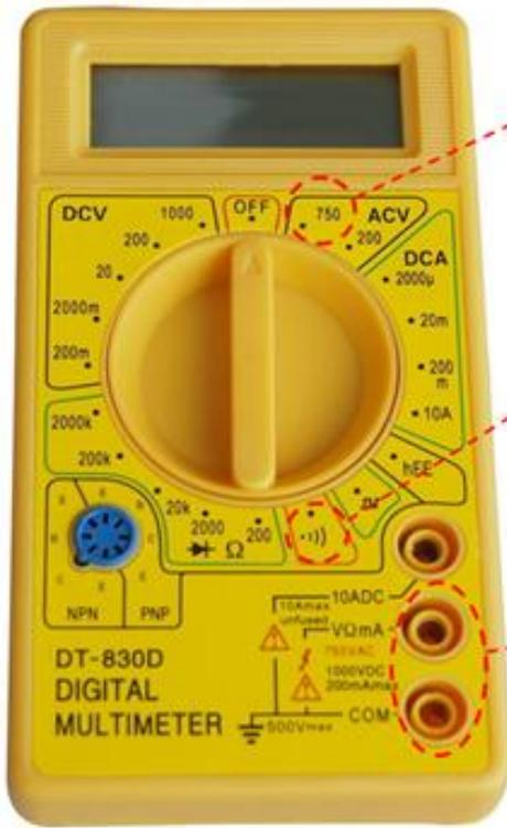
Para medir tensiones en alterna escogemos con el dial rotativo Voltaje en Alterna (ACV) y seleccionamos la tensión de 750V (ya que las tensiones que vamos a manejar generalmente serán de 230 V entre fase y neutro y de 400 V entre fase y fase).
