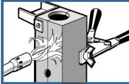
Antes de realizar la primera soldadura, es imprescindible precalentar el molde con una lámpara de soldar durante 5 minutos.
