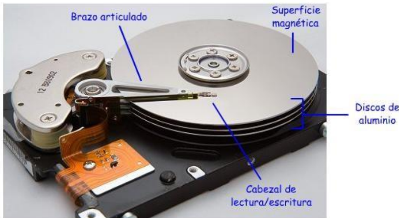
Disco duro sin la tapa de protección.
