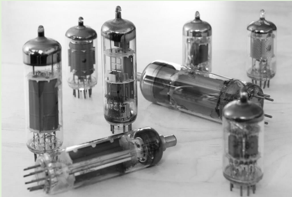
válvulas de vacío
