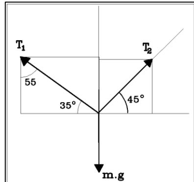
Como ves sustituín o debuxo por un esquema máis sinxelo. Agora só resta descompoñes as tensións nas suas componentes en X e en Y e resolver.
