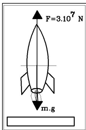
De acordo co esquema do debuxo, sobre o foguete atúan duas forzas, hacia ariba a propulsión e hacia abajo o peso. De acordo co 2º Principio:
