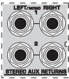
Fig.2.8: Conectores de retorno auxiliar estéreo
