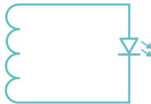
2. Sujetamos un extremo del hilo de cobre esmaltado y usando un trozo de tubo de 4 cm de diámetro, le damos sobre 20 vueltas. Cuando la tengamos lista debemos de sujetarla con cinta aislante para que no se deshaga.
