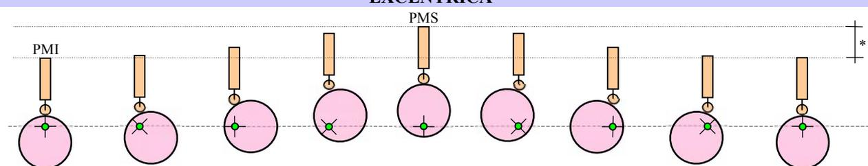
Son ruedas cuyo eje de giro no coincide con su centro geométrico. Se caracterizan porque el seguidor tiene un movimiento continuo.
