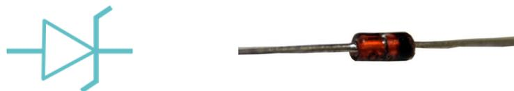
El **diodo rectificador** su principal uso es en circuitos rectificadores, es decir, circuitos que convierten la corriente alterna en continua, aunque también se usan como elemento de protección de otros componentes en circuitos electrónicos.
