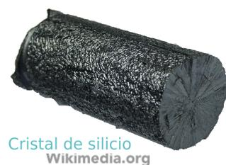
La estructura del silicio no tiene electrones libres y por lo tanto no permite el paso de la corriente eléctrica, es un aislante eléctrico. Para conseguir que conduzca la electricidad se le añaden **impurezas**, elementos químicos que tienen 3 o 5 electrones en su última capa de manera que producimos en el silicio un desequilibrio eléctrico. A este proceso se le denomina **dopaje**, y con él obtenemos los dos tipos de semiconductores utilizados para fabricar componentes electrónicos.
