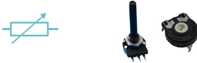
Se suelen usar para ajustar los circuitos electrónicos, para controlar la velocidad de giro de un motor o la intensidad lumínica de una lámpara.
