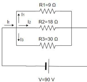
7. Determinar el valor de la resistencia total ( $R_T$ ), del conjunto de resistencias siguiente:
