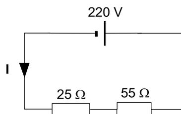
9. Dado el circuito de la figura, calcular el valor de la fuente de tensión ( $V$ ).
