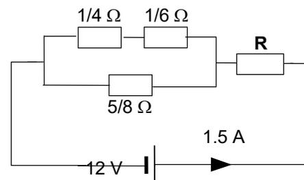
20. Calcular el valor de la resistencia " $R_1$ " que habría que conectar en el siguiente circuito para obtener una intensidad de corriente de 0.25 A.
