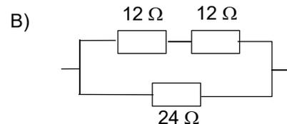
8. Aplicando la Ley de Ohm, determinar la intensidad de la corriente ( $I$ ), que circula por el circuito siguiente:
