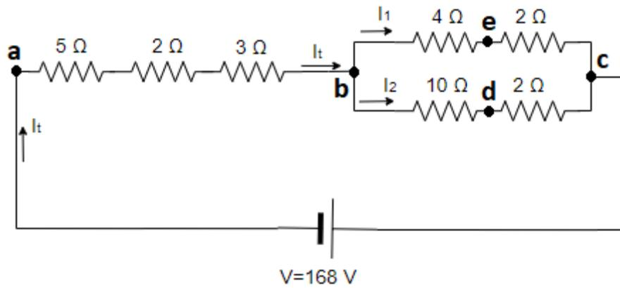
19. Dado el circuito de la figura, calcular el valor de la resistencia ( $R$ )
