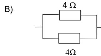
6. Determinar el valor de la resistencia total ( $R_T$ ), del conjunto de resistencias siguiente:
