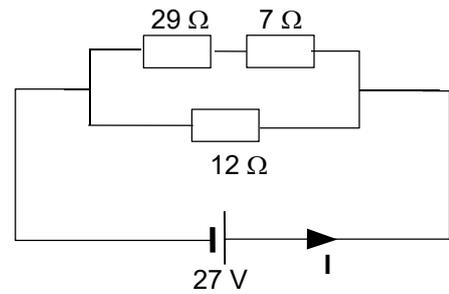
11. Hallar la resistencia equivalente de los siguientes circuitos:
