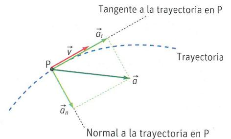
**Figura 8.7.** Componentes intrínsecas de la aceleración. La componente tangencial es siempre tangente a la trayectoria, mientras que la normal apunta hacia la parte cóncava.
