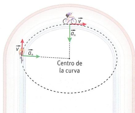
**Figura 8.8.** Vector aceleración normal en una trayectoria curva. El sentido del vector aceleración normal es hacia el centro de curvatura.
