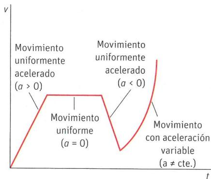
**Figura 8.6.** Gráfica  $v-t$ . Representa el módulo del vector velocidad frente al tiempo y no informa de la dirección de la velocidad.
