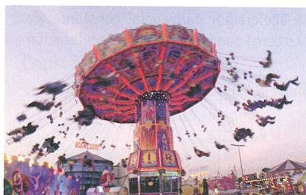
Si  $\vec{a}_n \neq 0$  y además  $a_t = 0$  el movimiento es **curvilíneo uniforme**. Por ejemplo, el del giro con  $|\vec{v}|$  constante de las sillas voladoras.
