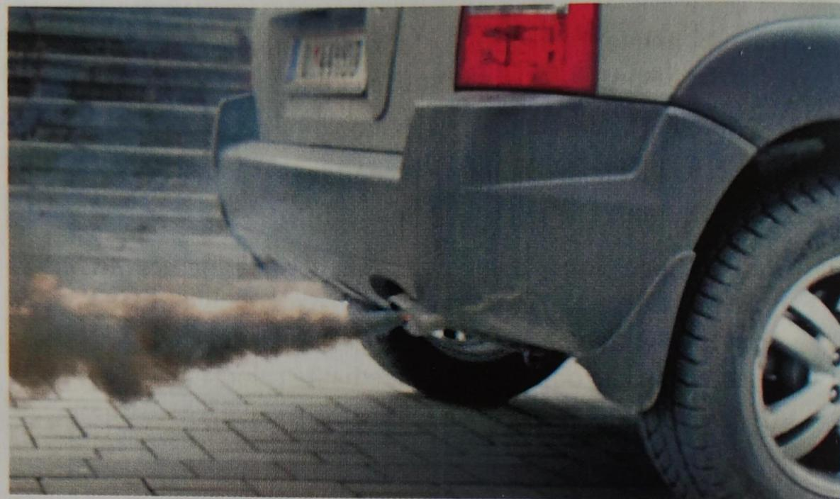
En esta reacción se **absorbe energía**. Este óxido indeseado se produce en el interior de los motores diésel y de gasolina, y en las centrales térmicas, debido a las altas temperaturas que se alcanzan. Es un contaminante atmosférico.
