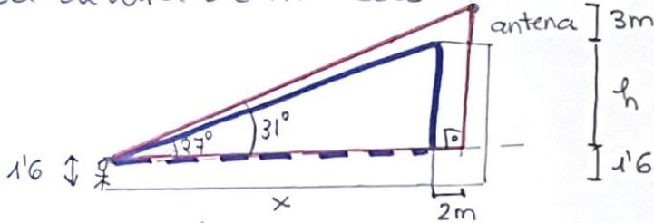
$$\operatorname{tg} 27^\circ = \frac{h}{x} \quad \left. \begin{array}{l} \text{(triángulo AZUL)} \\ \text{(triángulo ROJO)} \end{array} \right\}$$
