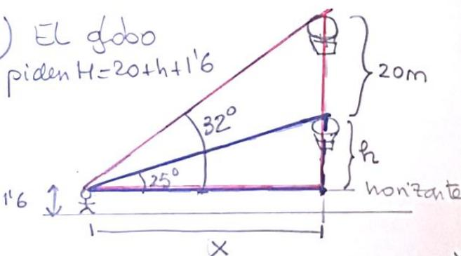
$$\begin{aligned} \text{triángulo azul } \operatorname{tg} 25^\circ &= \frac{h}{x} \\ \text{triángulo rojo } \operatorname{tg} 32^\circ &= \frac{h+20}{x} \end{aligned} \quad \left. \begin{array}{l} \text{despejo } x \text{ en } 1^{\text{a}} \text{ y sustituyo} \\ \text{en la } 2^{\text{a}} \end{array} \right\}$$
