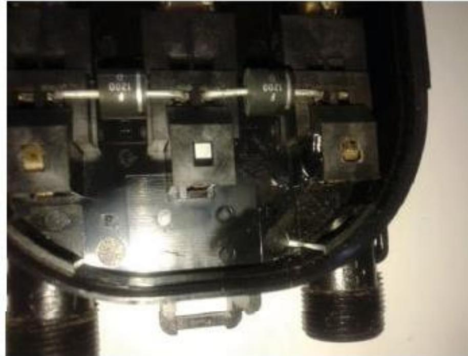
**Figura 4.21.** Caja de conexión de un módulo con diodos de paso (fuente: Sunfields).
