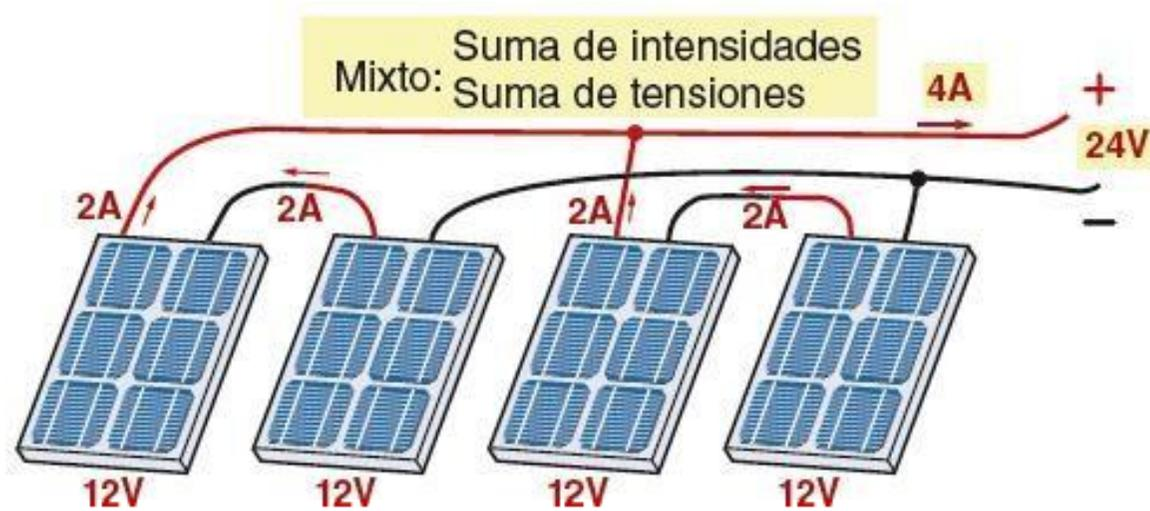
Figura 4.26. Conexión mixta de módulos.
