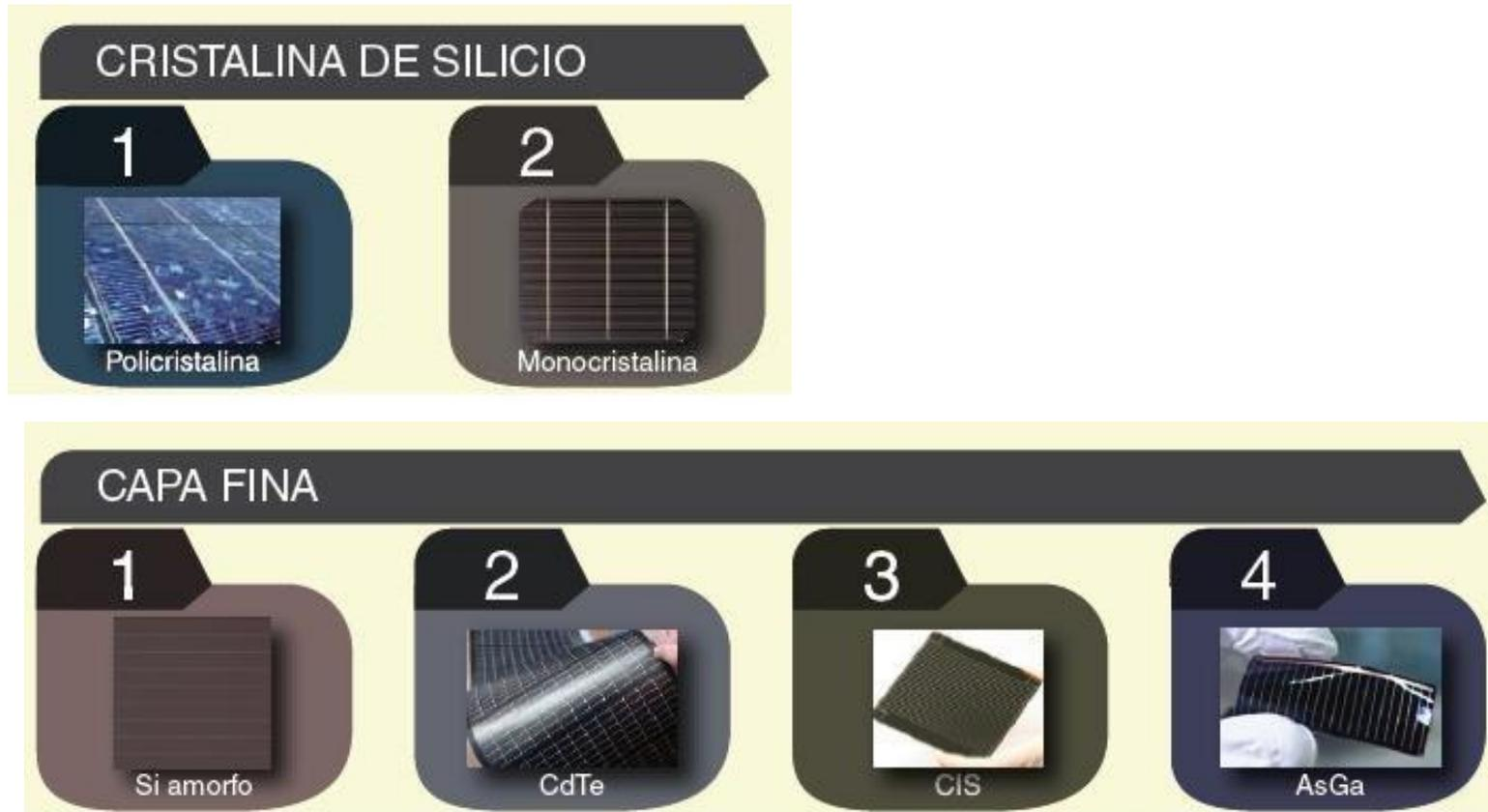
**Figura 4.9.** Clasificación de las distintas tecnologías comerciales de células FV.
