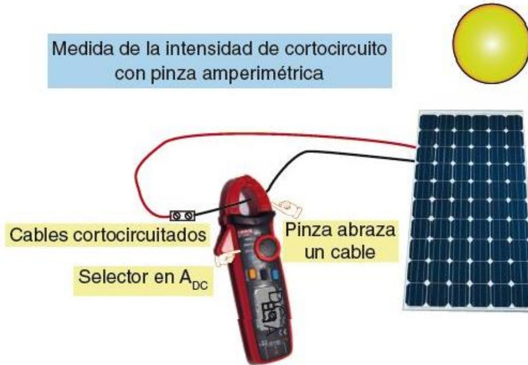
**Figura 4.30.** Medida de la corriente de cortocircuito con pinza amperimétrica.
