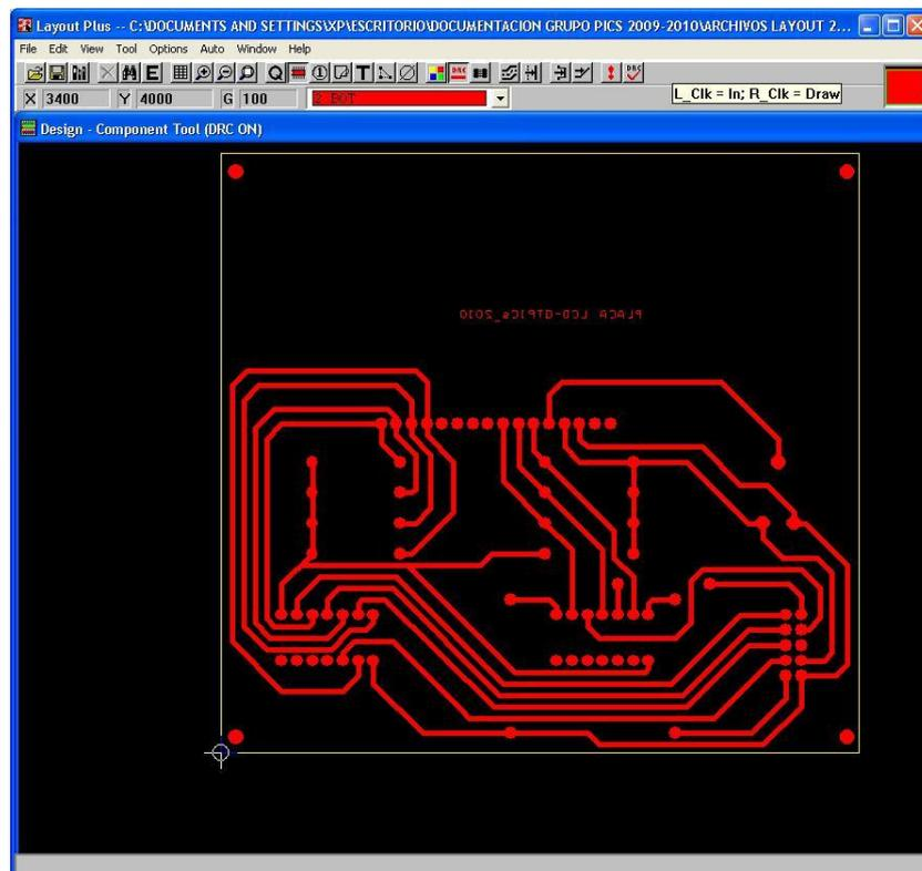
O seguinte proceso é a impresión destes esquemas en papel vexetal. Imos utilizar placa fotosensible de simple cara. Unha vez disposto o fotolito coa placa na insoladora, procedemos ao proceso de insolado axustando o tempo de exposición (podemos facer varias probas ata atopar o tempo correcto). Revelamos a placa e procedemos ao atacado obtendo un resultado como este:
