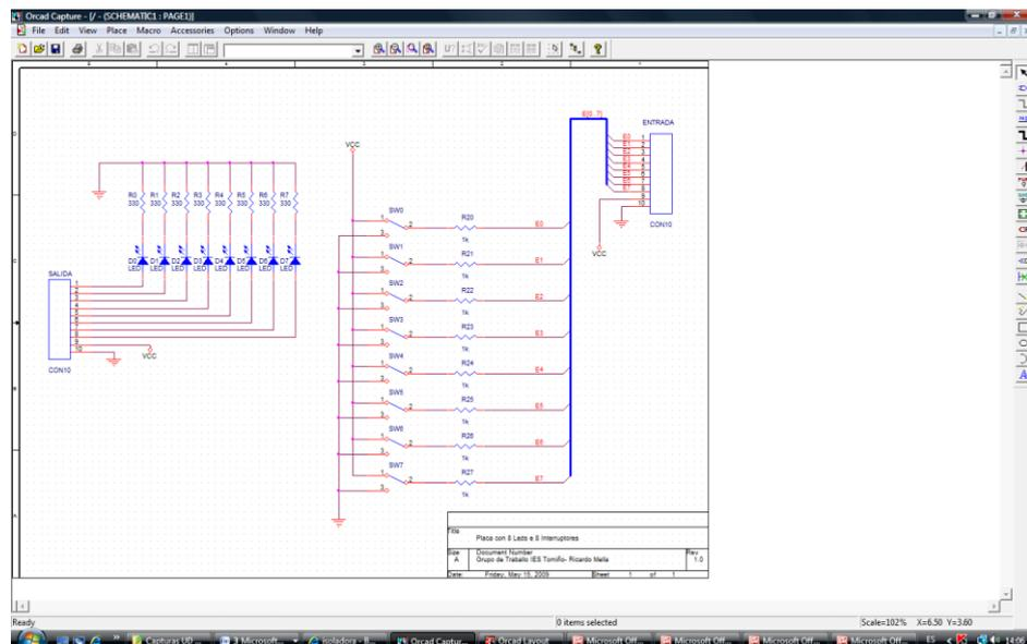
Comprobamos que tódolos compoñentes estean conexiónados adecuadamente coa ferramenta “Design Rules Check”, creamos a lista de materiais necesarios coa ferramenta “Bill of Materials” e finalmente creamos o ficheiro necesario para o programa OrCad Layout coa ferramenta “Create Netlist”.
