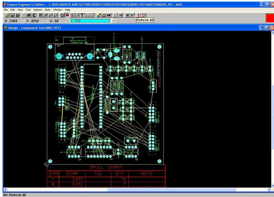
Procedemos ao proceso de rotado automático a dobre cara da placa, obtendo o deseño que aparece na seguinte figura:
