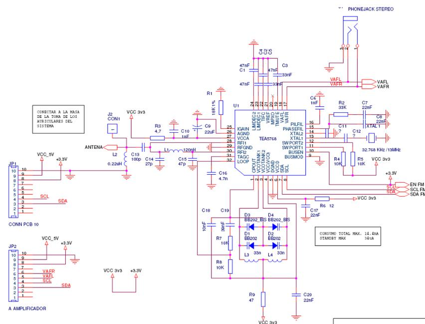
Comprobamos que tódolos compoñentes estean conexiónados adecuadamente coa ferramenta “Design Rules Check”, creamos a lista de materiais necesarios coa ferramenta “Bill of Materials” e finalmente creamos o ficheiro necesario para o programa OrCad Layout coa ferramenta “Create Netlist”.
