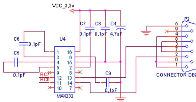
Os pins utilizados para esta comunicación serie son o RC6 (Tx) e o RC7 (Rx), liñas que utiliza a UART dos PICs e que levan integrada. Como dato a destacar, se o PIC non posúe unha UART poderíase implementar esta mediante software, mesmo algúns compiladores o implementan de forma automática (sen programación adicional pola nosa parte), indicándolle as liñas que van ser utilizadas como transmisión e como recepción.
