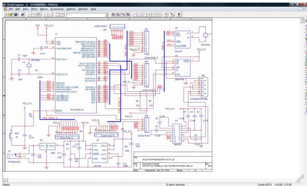
Comprobamos que tódolos compoñentes estean conexiónados adecuadamente coa ferramenta “Design Rules Check”, creamos a lista de materiais necesarios coa ferramenta “Bill of Materials” e finalmente creamos o ficheiro necesario para o programa OrCad Layout coa ferramenta “Create Netlist”.
