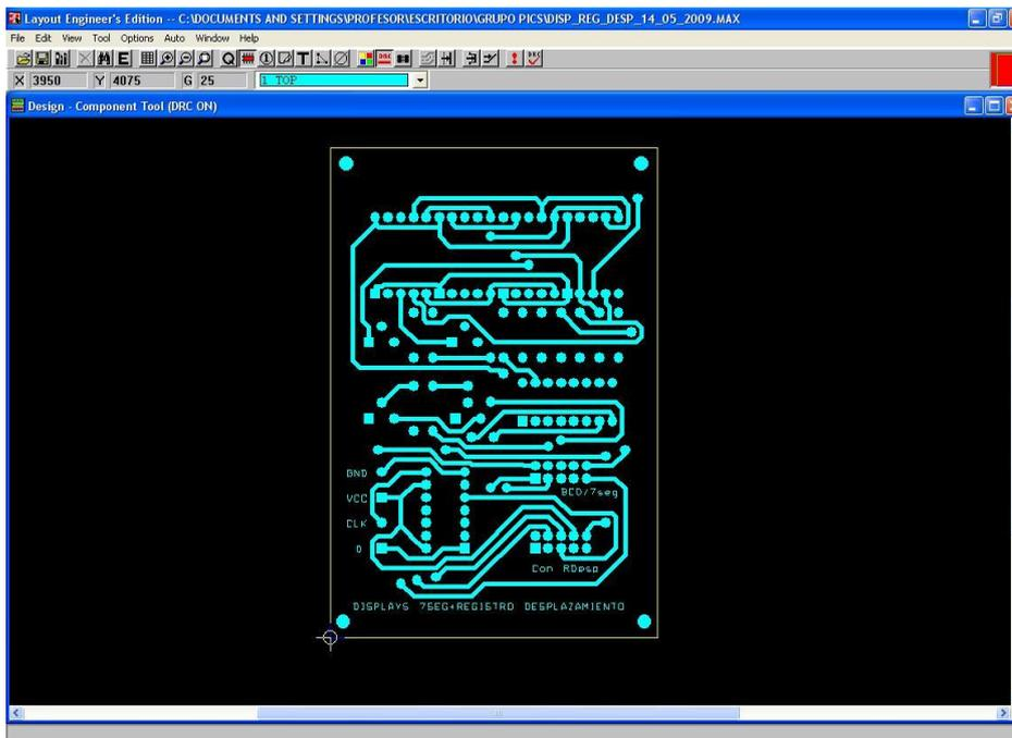
O seguinte proceso é a impresión destes esquemas en papel vexetal. Imos utilizar placa fotosensible de dobre cara. Debemos ter a precaución para o proceso de revelado que os fotolitos coincidan perfectamente e non teñamos erros na placa final. Unha vez dispostos os fotolitos coa placa na insoladora (ten que ser de dobre cara), procedemos ao proceso de
