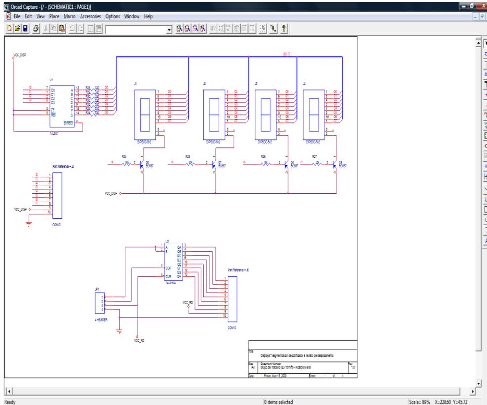
Comprobamos que tódolos compoñentes estean conexiónados adecuadamente coa ferramenta “Design Rules Check”, creamos a lista de materiais necesarios coa ferramenta “Bill of Materials” e finalmente creamos o ficheiro necesario para o programa OrCad Layout coa ferramenta “Create Netlist”.
