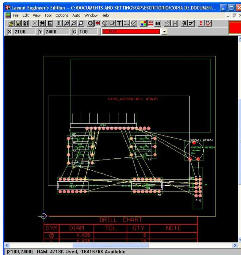
Procedemos ao proceso de rotado automático a simple cara da placa, co que obtemos o deseño de pistas da placa tal e como vemos na seguinte figura:
