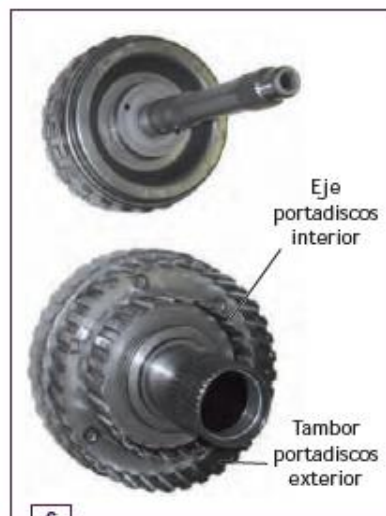
6 Embrague multidisco de un cambio epicycloidal.
