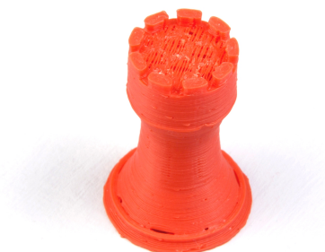
Fig. 14: Un ejemplo de un modelo impreso con insuficiencia de capas superiores.
