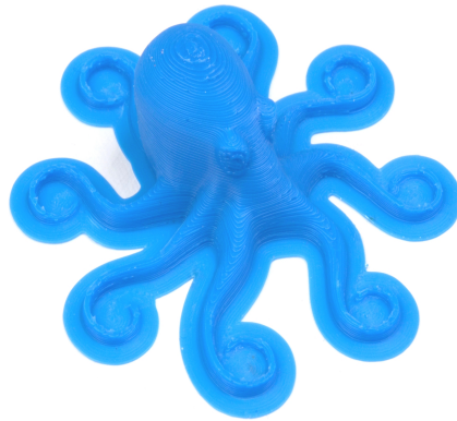
Fig. 17: Ejemplo de modelo impreso con brim (refuerzo de adherencia, o borde)
