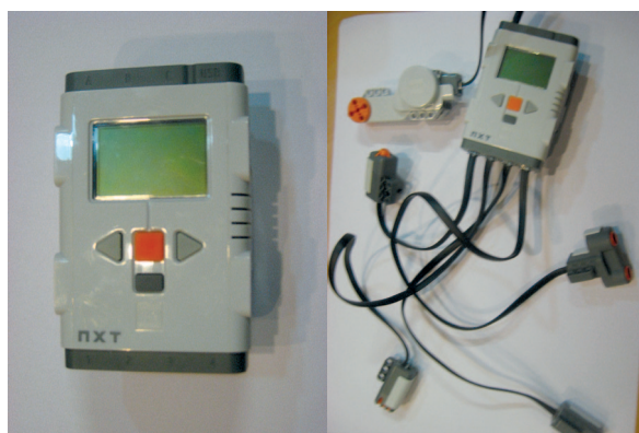
Fig 3. À esquerda: o Lego Mindstorm NXT® “bloco processador” que inclui um visor com: um conjunto de menus para programas de teste já instalados; programas criados pelas crianças através da interface ou diretamente no “bloco processador”; os sensores e os atuadores ligados; mensagens de Bluetooth, etc. As setas podem ser usadas para navegar nos menus, o botão laranja para executar o programa, o botão cinza para voltar ao menu, ou para desligar o robot. À direita: sensores e atuadores ligados ao processador.
