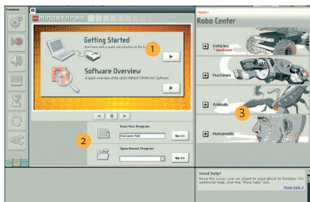
Fig 1. A aplicação Lego NXT: (1) O Tutorial “Getting started”, (2), área para criar um novo projeto, e (3) O “Robot Center”, com instruções de montagem e de programação.
