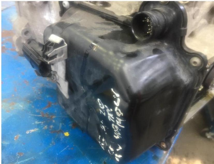
Soltamos el conector eléctrico del sensor alojado en la cámara embrague. Es el que suministra las señales de régimen de entrada al cambio y temperatura del aceite centrífugo
