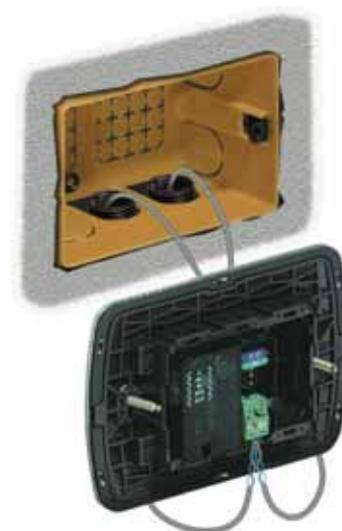
El mismo comando realizado con el cableado con BUS permite obtener exactamente la misma funcionalidad operativa, pero con un notable ahorro de conductores. La modificación de los puntos de comando o de las modalidades operativas no implica la alteración del cableado, solo es necesaria la configuración del mismo dispositivo.
