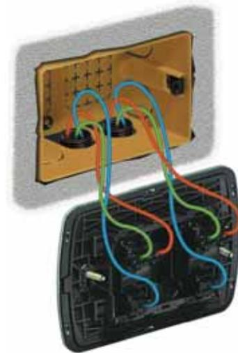
En un edificio, realizado con cableado tradicional, el comando de dos luces distintas en varios puntos implica la instalación de un considerable número de conductores. Luego, la adición de un nuevo punto de comando al interior de la misma caja aumenta notablemente la complejidad del cableado y reduce el espacio dentro de la misma caja.
