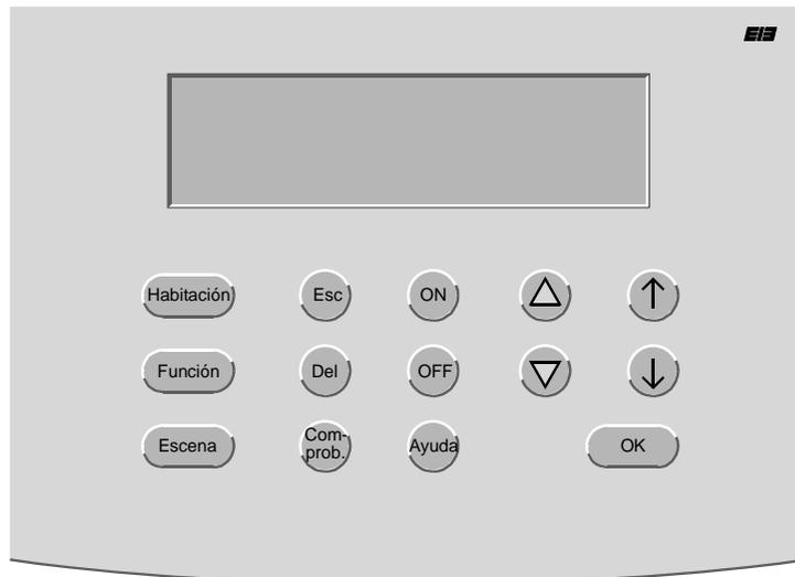
Fig. 3.3-2 El controlador *EIB powerline*
