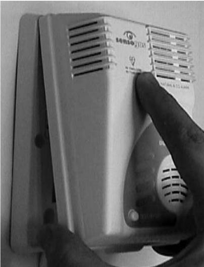
Una vez que el soporte está sujeto a la pared coloque la caja del detector en la misma posición de origen. Primeramente inserte los ganchos superiores de la caja sobre el soporte y gire suavemente hacia la posición vertical hasta que la pestaña inferior quede encajada en el soporte, teniendo cuidado de la correcta conexión de los contactos traseros de la caja en el borne de conexión (Ver Figura 5).
