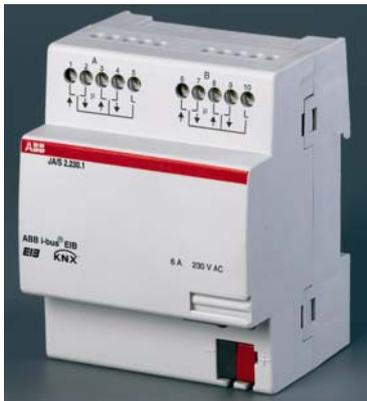
El actuador de persianas de dos salidas es un componente para montar sobre un perfil DIN, (3 o 4 módulos), que puede insertarse en el cuadro de distribución. Se conecta al EIB a través de un borne de conexión al bus.
