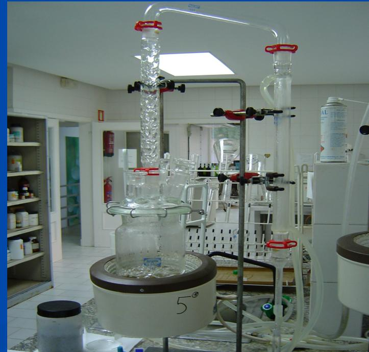
Para la determinación del azúcar presente en el orujo los métodos usuales se basan en realizar una infusión del bagazo con agua en baño maría durante 4 horas con posterior filtración y determinación de los azúcares por cualquier de los métodos usuales (refractometría, defecación en una cantidad determinada de disolución cupro-alcalina con posterior determinación del exceso de iones de cobre presentes).
