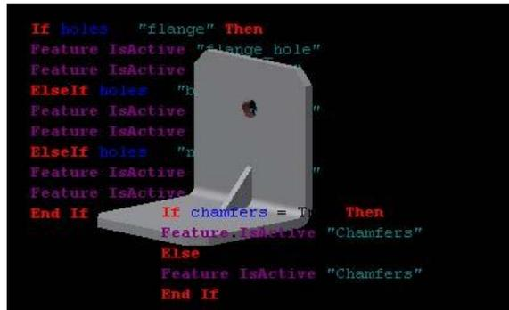
iLogic le ayuda a crear modelos basados en normas. Las reglas se incrustan como objetos en los documentos de pieza, ensamblaje y dibujo. Utilice iLogic para controlar el diseño según los cambios en los valores de parámetros de Inventor.
