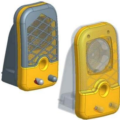
Las piezas con varios cuerpos se utilizan para controlar las curvas complejas que se extienden a varias piezas en el diseño de piezas de plástico o los modelos orgánicos.
