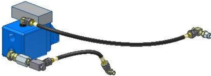
Los enrutamientos de manguera flexible en un ensamblaje de tubos y tuberías se utilizan por lo general en la fabricación de máquinas y equipos para transmitir potencia dinámica, como potencia hidráulica y neumática. Se definen mediante la inserción de accesorios y nodos de manguera que determinan la forma y el aspecto del enrutamiento en el ensamblaje. El estilo de manguera flexible controla los accesorios que se utilizan y la estructura de la manguera flexible en el ensamblaje.
