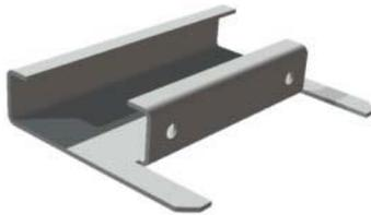
Es probable que el diseño que le han pedido que cree contenga componentes que deban fabricarse en chapa. Autodesk Inventor proporciona funciones que simplifican la creación, la edición y la documentación de los prototipos digitales de los componentes de chapa.
