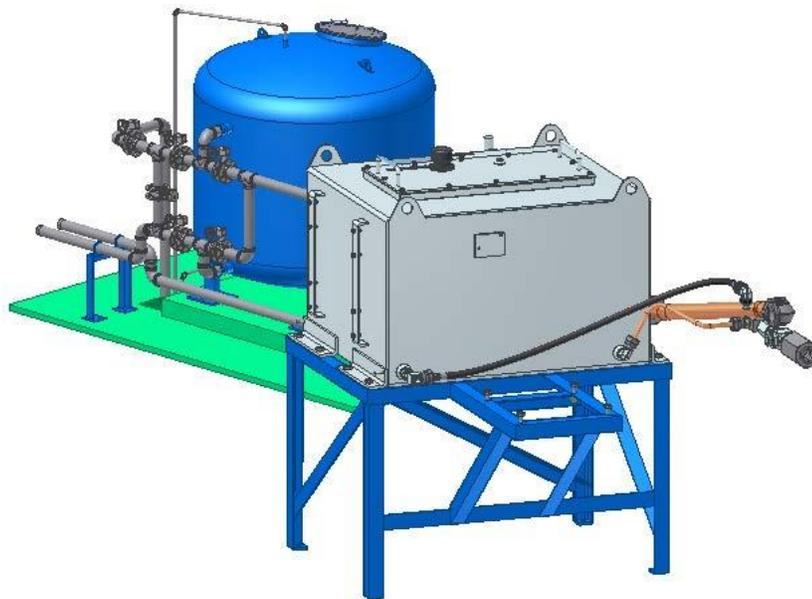
Tubos y tuberías es un complemento para el entorno de ensamblaje de Autodesk®Inventor®. Proporciona los medios para crear sistemas completos de tubos y tuberías en diseños de ensamblaje mecánico.
