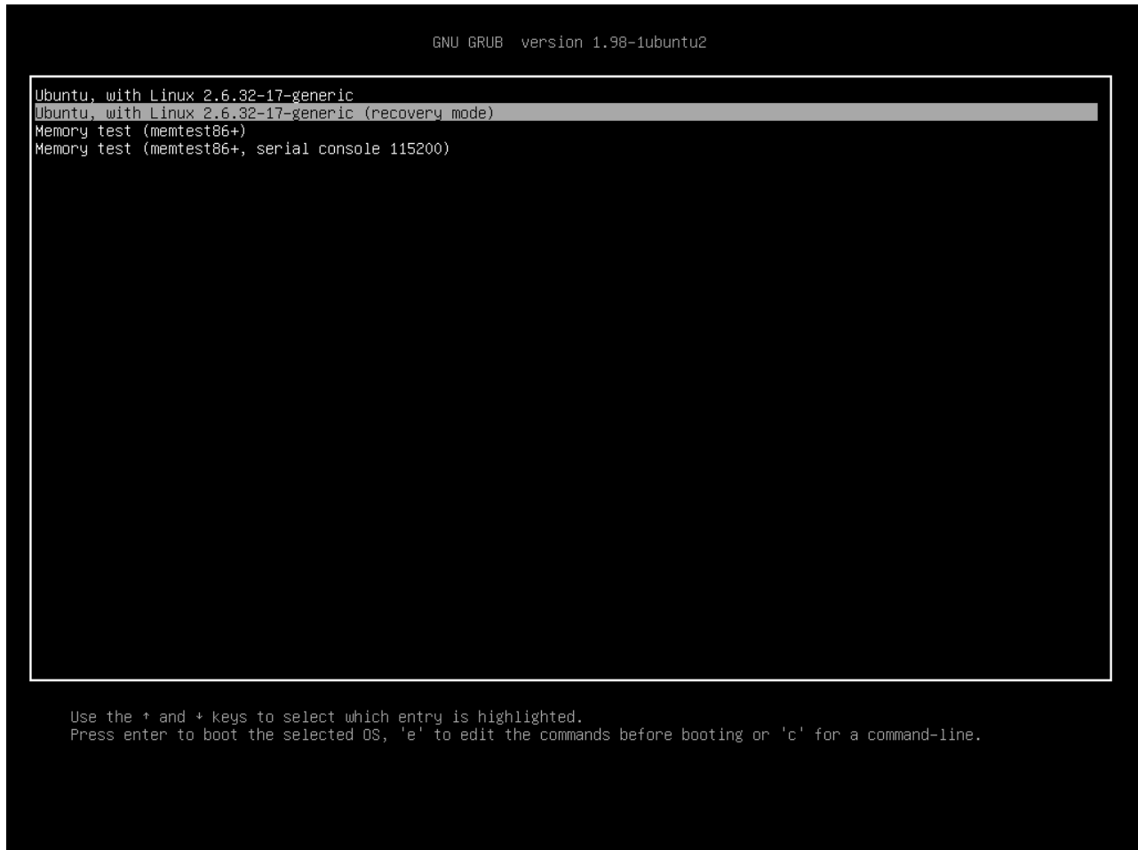
Figura 8.1: Esta é a pantalla de grub na cal pode seleccionar o modo de rescate.
