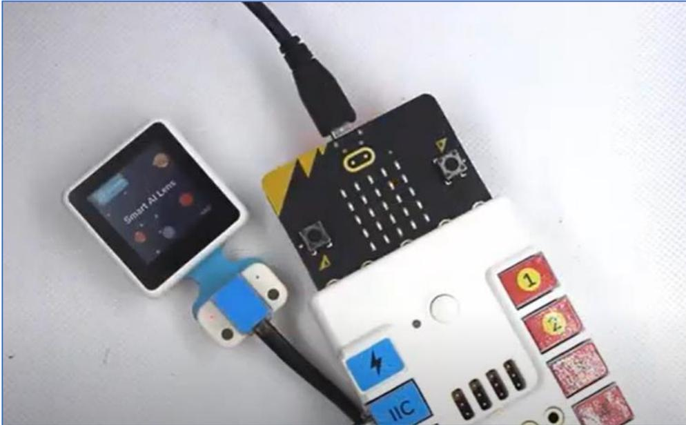
Smart AI Lens dispone de una cámara que va a captar la imagen, una pantalla que nos va a enviar la imagen de la cámara y sobre la pantalla se verán los datos que el sensor reconoce internamente.
