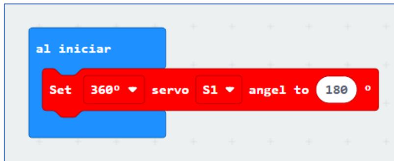
Cargamos el programa a la placa y vemos que el servomotor se mueva. Cuando finalice de moverse ya podemos colocar la barra.
