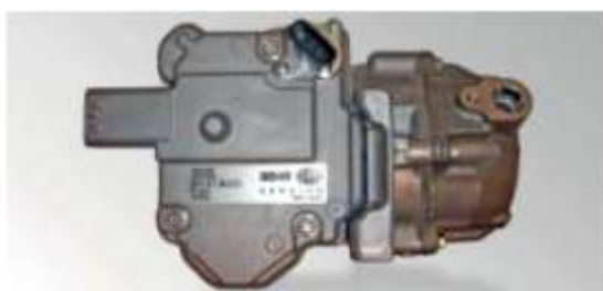
Compresor de alto voltaje
